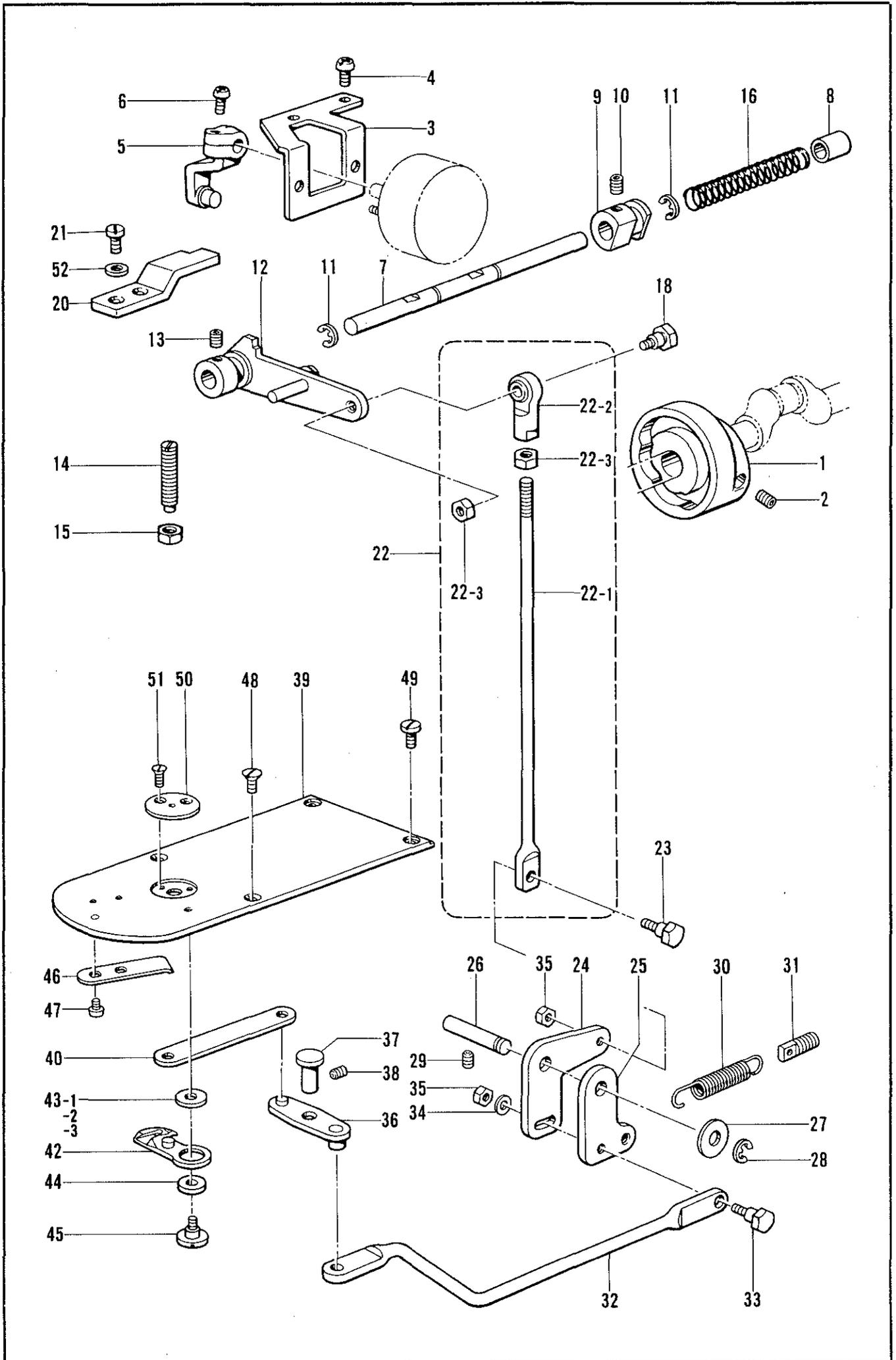
K. 糸切り関係/Thread trimmer mechanism/Fadenabschneidevorrichtung/
