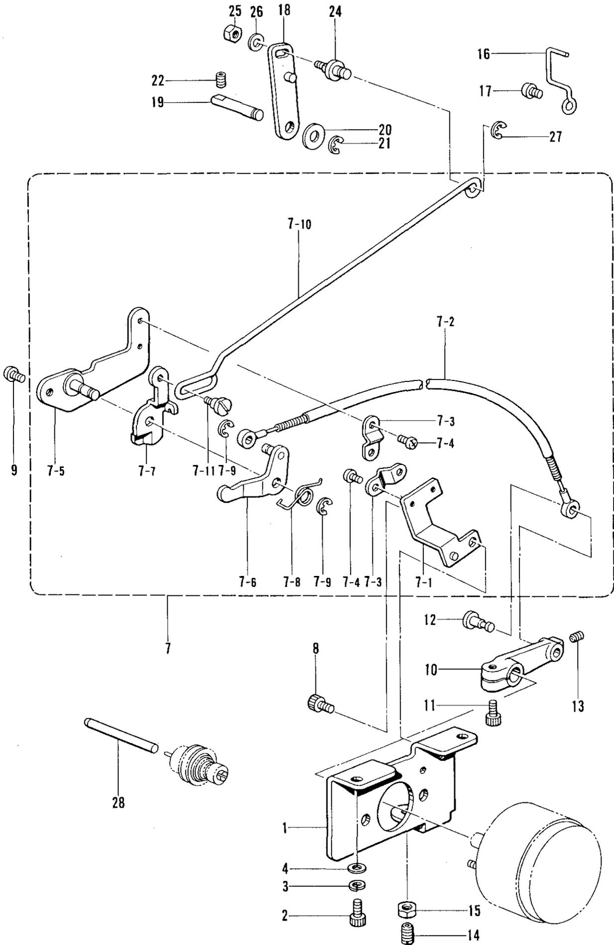
N. 糸締メ関係/Thread nipper mechanism/Fadenspannvorrichtung/
