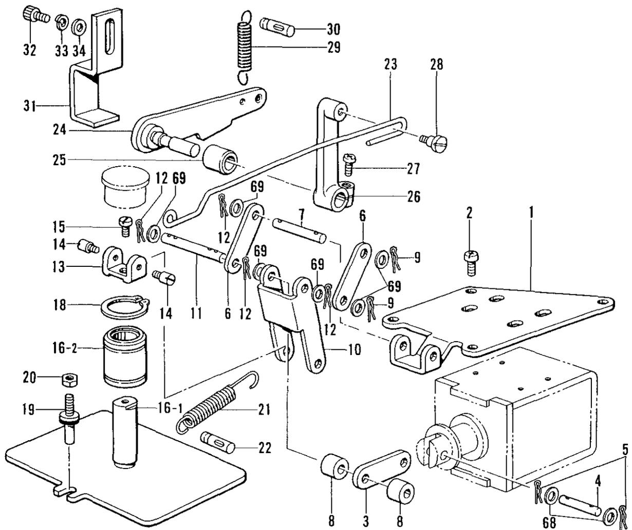
D. 押工上げ関係/Work clamp lifter mechanism/Stoffhalterhebervorrichtung/
