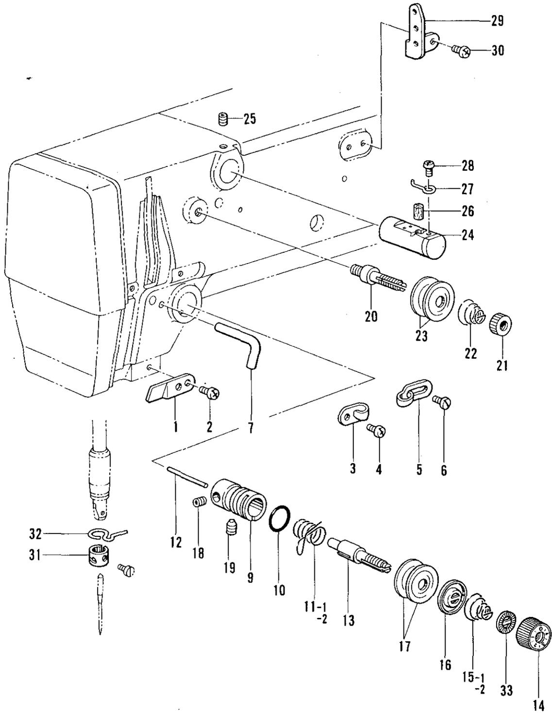
H. 糸通シ関係/Threading mechanism/FadenführungsVorrichtung/
